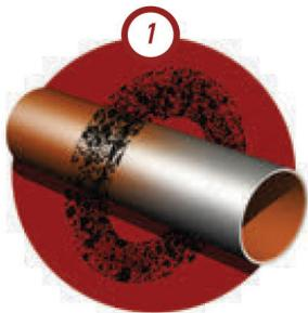
**ДРОБЕМЕТНАЯ ОБРАБОТКА НАРУЖНОЙ ПОВЕРХНОСТИ**
