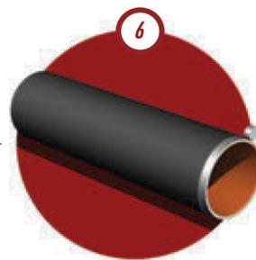
**ЩЕТОЧНАЯ ОЧИСТКА КОНЦОВ ТРУБ ОТ ПОКРЫТИЯ И ФОРМИРОВАНИЕ ФАСКИ ПОКРЫТИЯ**
